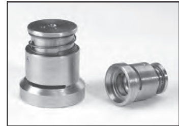
Fig. Q119 — Captive O-Ring Assembly Tool
